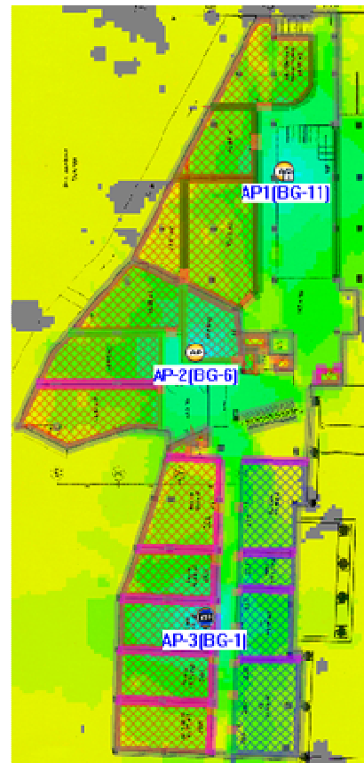
Gambar 11. Penyebaran sinyal sebelum optimasi
