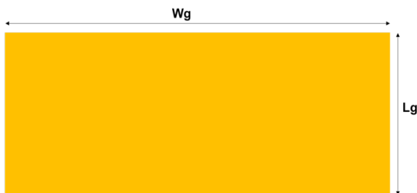
Gambar 4 Desain tampak belakang dari antena microstrip 2x1 elemen
