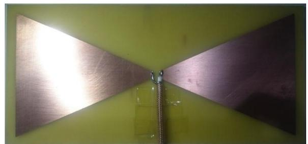
Gambar 12 Hasil realisasi antena mikrostrip *bow-tie*
