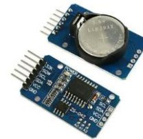
Gambar 5 Modul RTC DS3231 Sumber: laskarduino.cz/vstupni-periferie-ostatni/133002-rtc-hodiny-realneho-casu-ds3231-at24c32-iic.html
