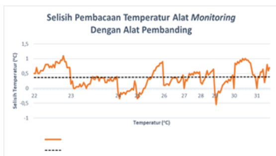
Gambar 13 Grafik Akurasi Sensor Temperatur Terhadap Temperatur
