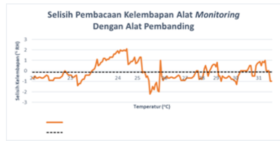
Gambar 14 Grafik Akurasi Sensor Kelembapan Terhadap Temperatur
