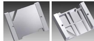
Gambar 4 Dua buah permukaan benda kerja dalam dua stage [8]
