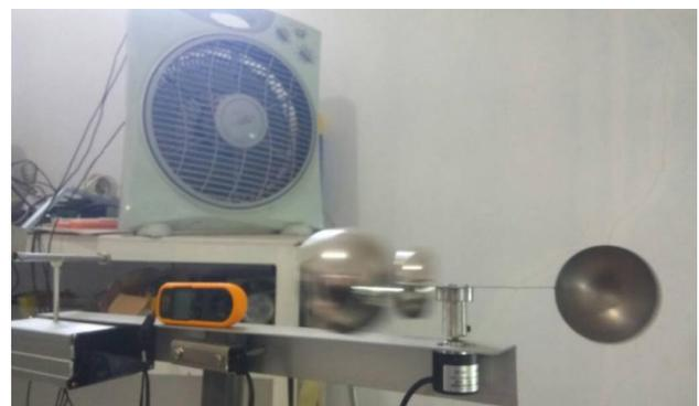
Gambar 12 Kondisi pengujian dengan kipas angin, anemometer, dan kompas.
