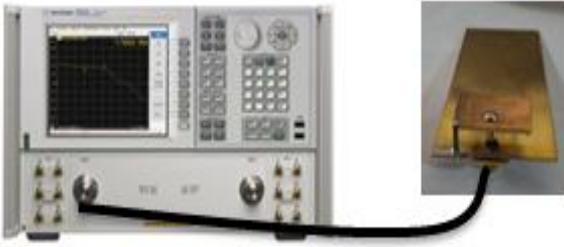
Gambar 7 Konfigurasi pengukuran VSWR, *bandwidth* dan impedansi
