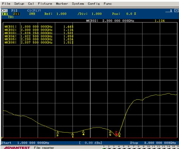
Gambar 12 Hasil pengukuran VSWR antenna *L-slot*
